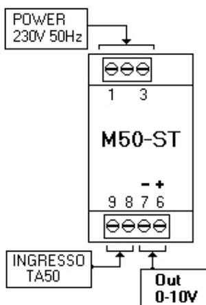
Modulo di conversione segnale con TA50 in dotazione 0-50 Amp. e uscita 0-10V. E' possibile portare un il TA50 a una distanza che va da 0,5 a 50mt. dal modulo.
